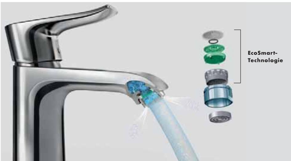
**Der Präzisions-O-Ring reagiert flexibel: Ist der Wasserdruck hoch, verkleinert er die Durchtrittsöffnung. Ist er niedrig, vergrößert er die Öffnung.**
